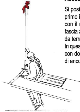
Accesso al primo impalcato
